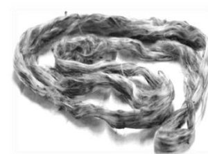
リサイクルした不連続炭素繊維から作製したスライバー(撚糸前の材料)
